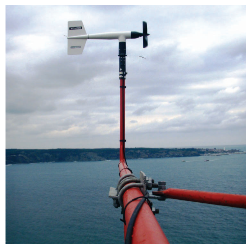
Mât de mesure sur un site équipé d'un anémomètre à hélice
