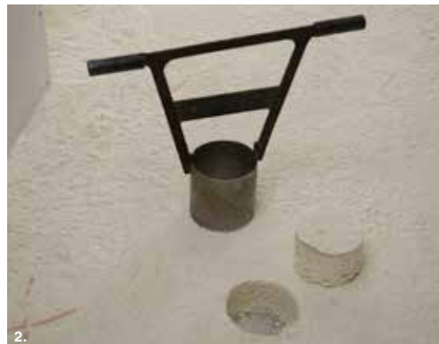
2. Carottage de contrôle. 3. Projection murale de polyuréthane.
