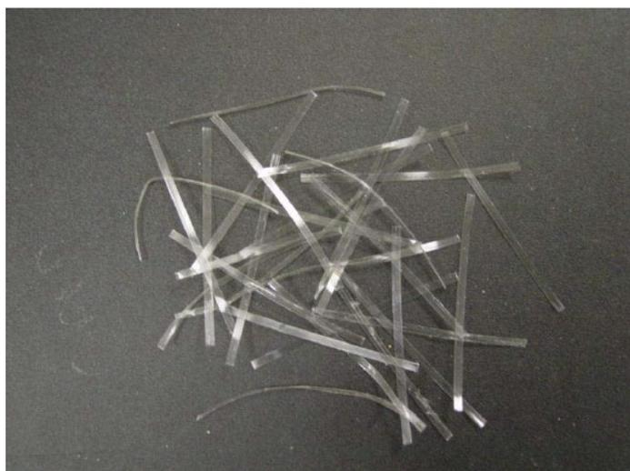
Photo 1 : fibre STRUX® vierge, avant introduction dans béton
