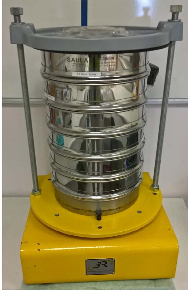
Figure 3 : Tamiseur vibrant équipé de tamis 6,3/3,15/2/1/0,5/0,25 mm
