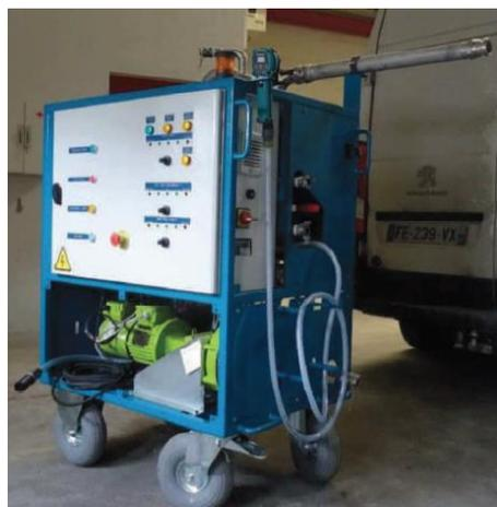
Figure 10 - Génératrice de mousse (Foambox)
