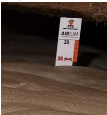
Figure 11 – Mesure de l'épaisseur de l'isolant
