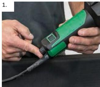
La température de soudure est comprise entre 500°C (repère 8 du bouton de réglage) et 700°C (repère 10 du bouton de réglage). La température est ajustée en fonction des conditions climatiques.
