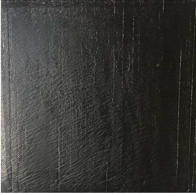
**Figures 7 – Sous-face de la membrane RESITRIX MB**
