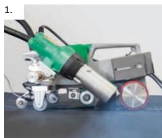
La température de soudure est de 620°C, le bouton de réglage doit être porté à son maximum.
