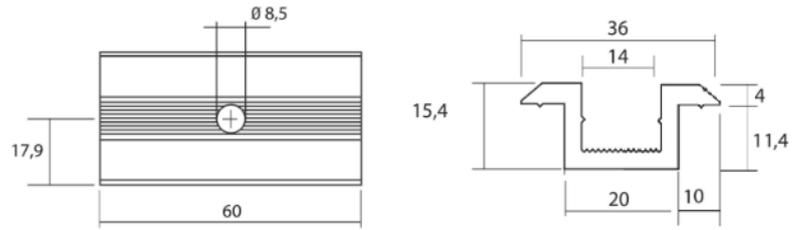
**Figure 5 - Brides latérales – Cadre du module de hauteur 35 mm**
