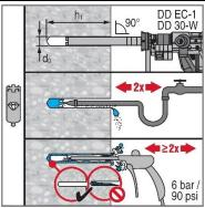
c) Carottage diamant (DD): M8 à M20
