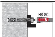
b) Vissage à la machine (outil de pré-installation):
