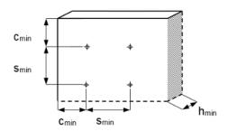
Pour le calcul de la distance minimale au bord et de l'espacement en combinaison avec des profondeurs d'encastrement et des épaisseurs de dalle variables, l'équation suivante doit être remplie :
