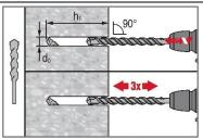
Perçage par percussion Absence de nettoyage (HD NC): M8 à M20
