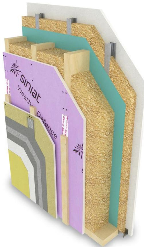
**Figure 1 : Vue perspective : Jonction verticale avec plaques bord à bord**
