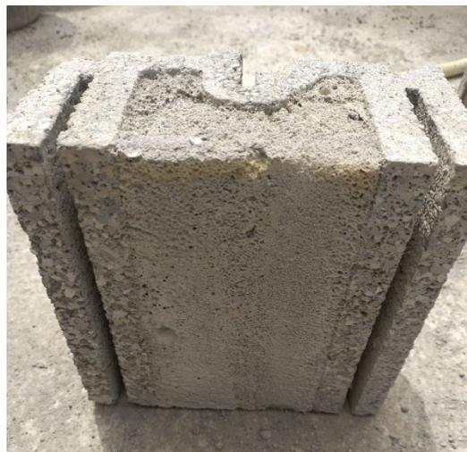
Figure 2 : exemple d'éléments de maçonnerie avec remplissage en Aircimat (à droite : vue en coupe après sciage de l'élément de maçonnerie montrant la bonne adhérence entre le noyau en Aircimat et les cloisons internes)
