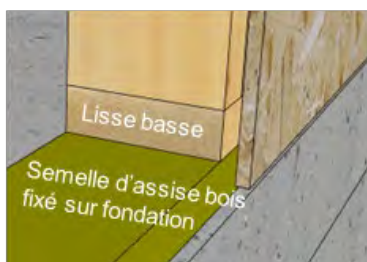
Figure 3 : Principe de pose de l'élément préfabriqué avec procédé TERLIAN MUR PREFABRIQUE BOIS avec lisse d'implantation
