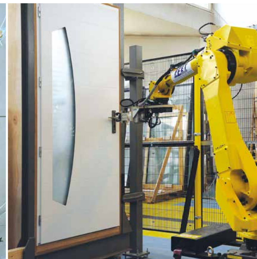
Essai d'ouverture fermeture du bloc-porte
