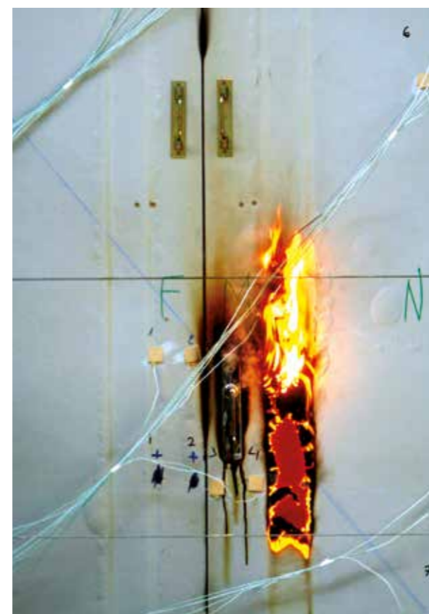
Essai de résistance au feu sur four ISO
