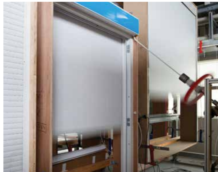
Banc d'endurance mécanique : les volets sont soumis à des cycles de repliement-dépliement (7 000, 10 000 ou 14 000) équivalents à plusieurs années d'utilisation.
