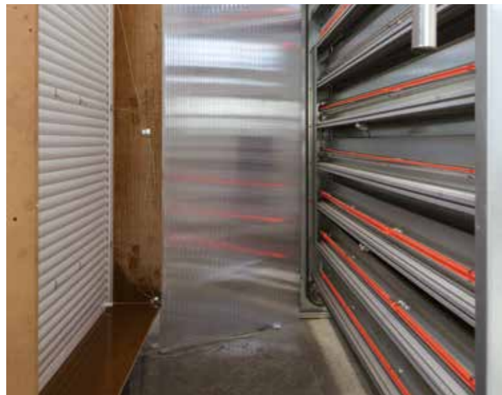
Banc d'ensoleillement : les tabliers sont soumis durant 6 heures à des températures de 50° pour les tabliers blancs et clairs et 70° pour les tabliers foncés, puis subissent des chocs thermiques.
