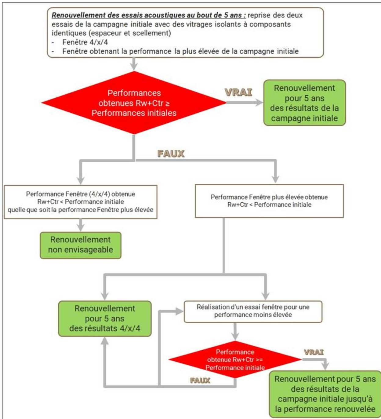
Renouvellement des essais à 10 ans : Méthodologie identique avec des essais réalisés sur des fenêtres pour prolonger la campagne validée des 5 ans.
