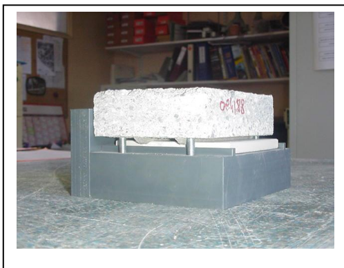
Photo 3 : Mise place de la dalle sur le carreau
