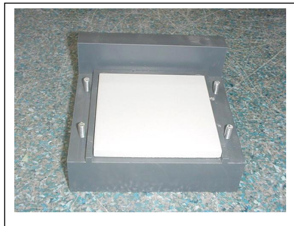
Photo 2 : Mise en place du carreau dans le gabarit
