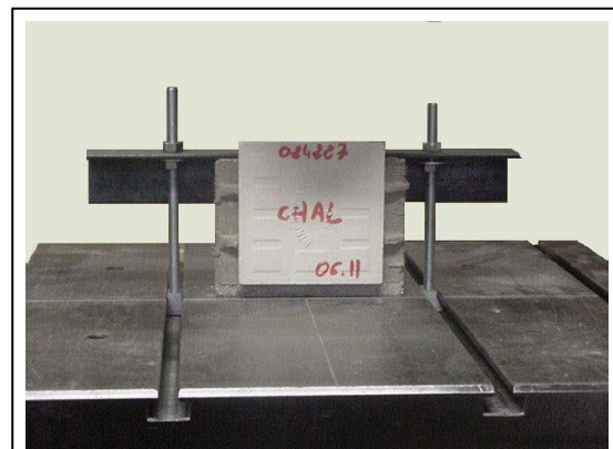
Photo 4 : Maintien de la dalle (exemple)
