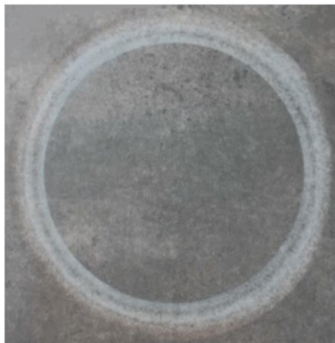
Carreau lisse, cercle continu, « limite » mauvais
