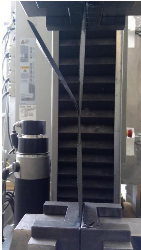
Figure 3 Essai de cisaillement sur jonction de deux écrans souples avec un collage par ruban adhésif rapporté (non visible)
