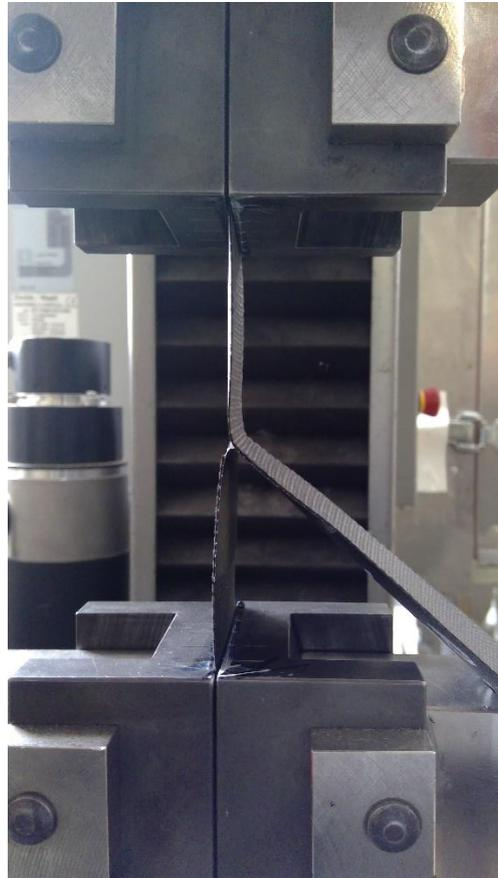
**Figure 5 Essai de pelage sur jonction de deux écrans souples avec un collage par ruban adhésif rapporté (non visible)**
