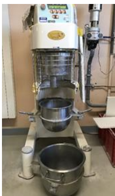
Malaxeur type Rayneri avec bol de 10 L et 20 L
