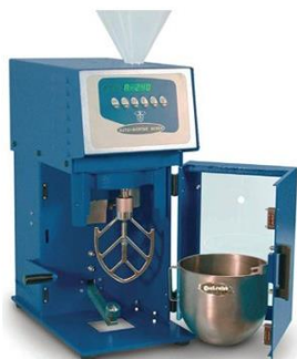
Malaxeur à mortier type Perrier avec bol de 5 L
