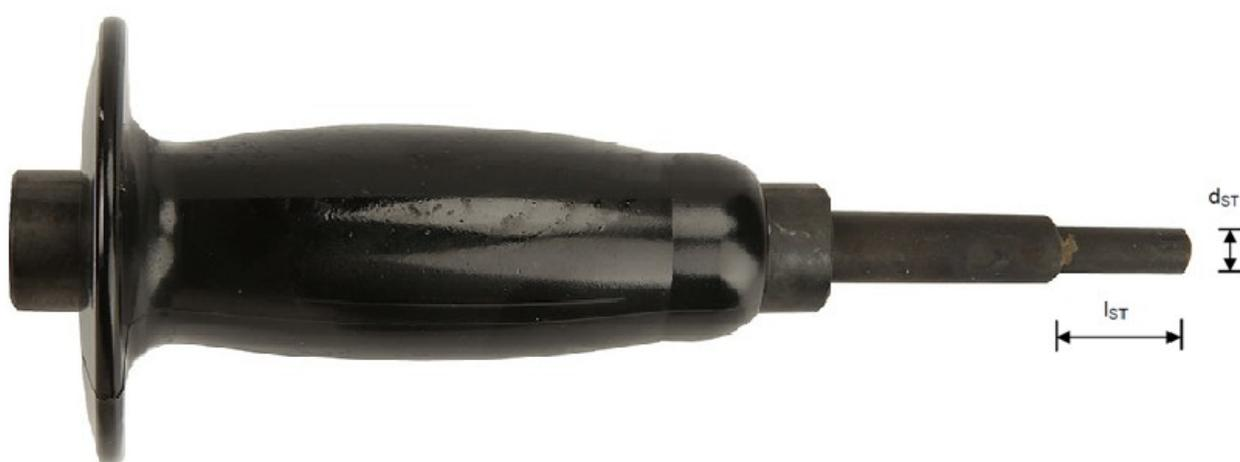
L'outil de pose avec fonction de marquage réalise une empreinte sur le sommet de la cheville lorsque celle-ci est correctement installée. Cette marque permet de vérifier après l'installation que la cheville est correctement expansée.
