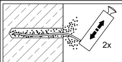
La pompe manuelle peut être utilisée pour souffler dans des trous de diamètres  $\leq \varnothing 22$  mm et de profondeur d'ancrage jusqu'à  $h_{ef} \leq 10d$ . Chasser la poussière en soufflant 2 fois avec la pompe manuelle depuis le fond du trou.
