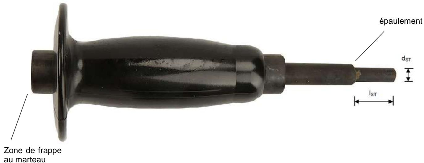
L'outil de pose avec fonction de marquage réalise une empreinte sur le sommet de la cheville lorsque celle-ci est correctement installée. Cette marque permet de vérifier après l'installation que la cheville est correctement expansée.
