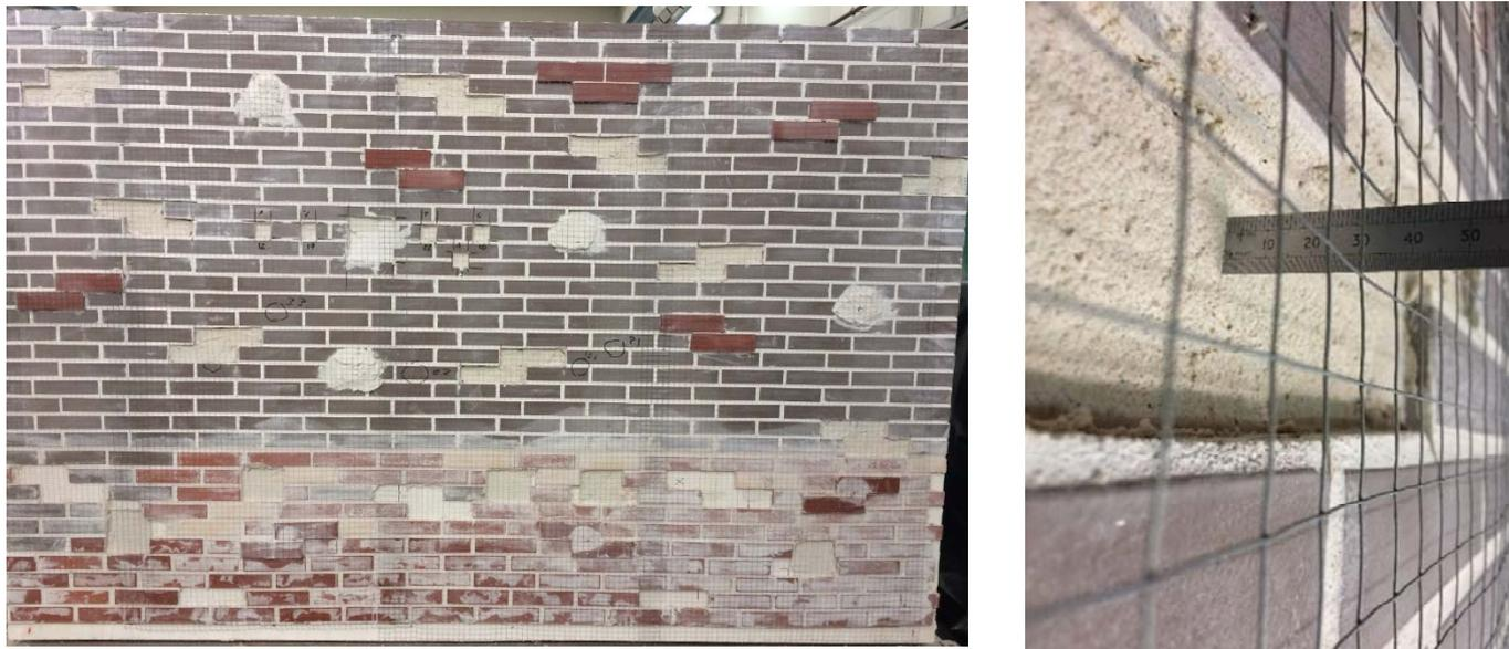
Figure 3 : Maquette avec treillis métallique : vue générale et détail au niveau d'un relief négatif
