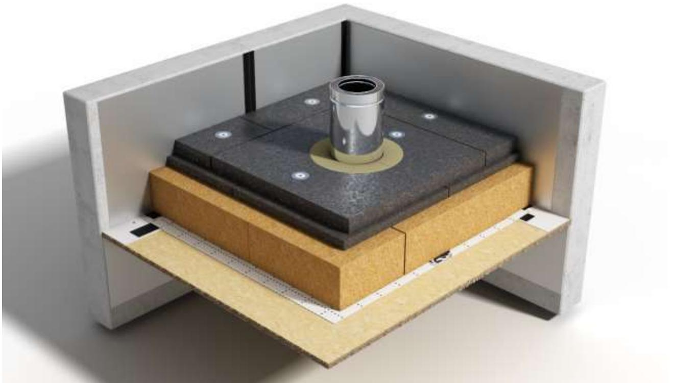
**Figure 32 : Pose des lits d'isolant du système PAVAROOF.**
