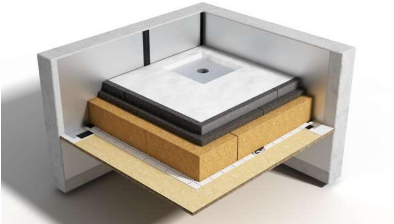
**Figure 26 : Pose de l'écran de séparation SOPRAVOILE 100, pose et fixation de l'EEP.**
