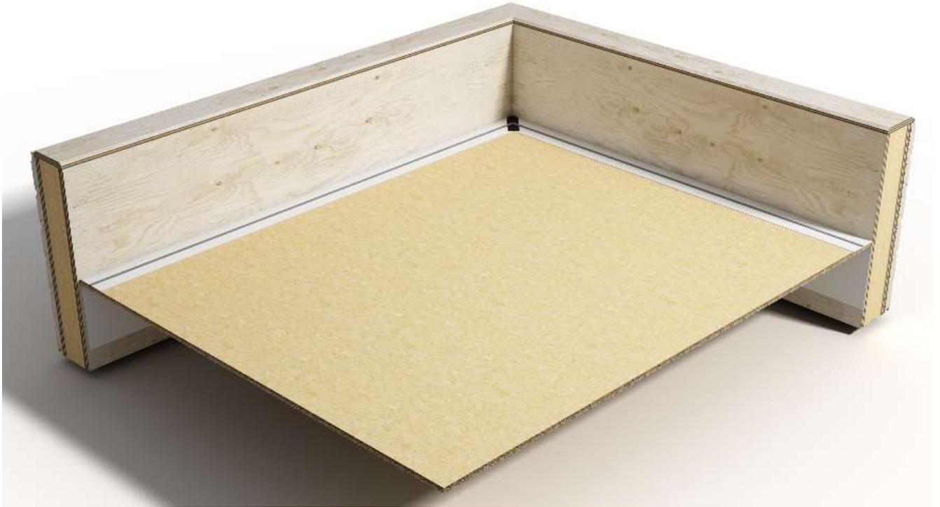
**Figure 15 : Pose de l'élément porteur avec retour de pare-vapeur mural intérieur, pose du mastic PAVABOND sur le retour du pare-vapeur mural et pose de l'adhésif PAVAFIX 60 en jonction de pare-vapeur.**
