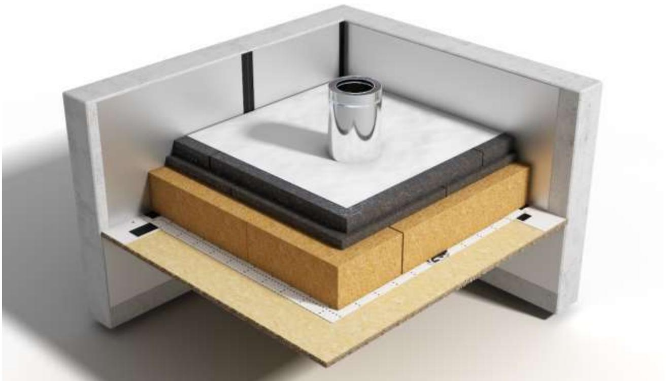
**Figure 33 : Pose de l'écran de séparation SOPRAVOILE 100.**
