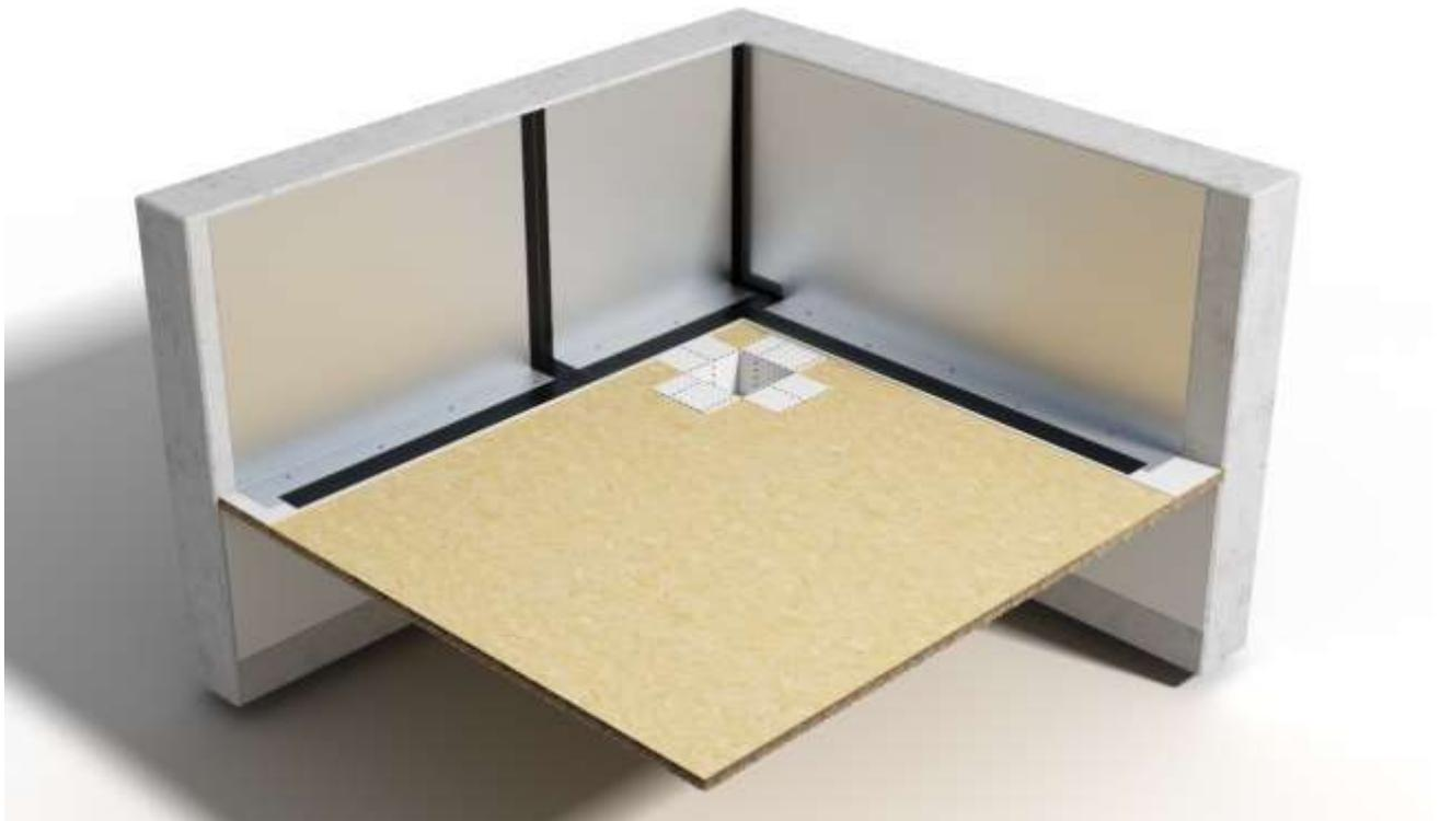
**Figure 20 : Pose du manchon de pare-vapeur avec rabat des ailettes sur l'élément porteur.**
