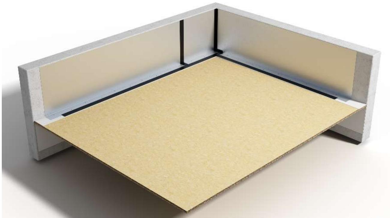
**Figure 3 : Pose de l'élément porteur avec retour de pare-vapeur mural intérieur, pose des costières métalliques et de l'adhésif PAVAFIX 60.**
