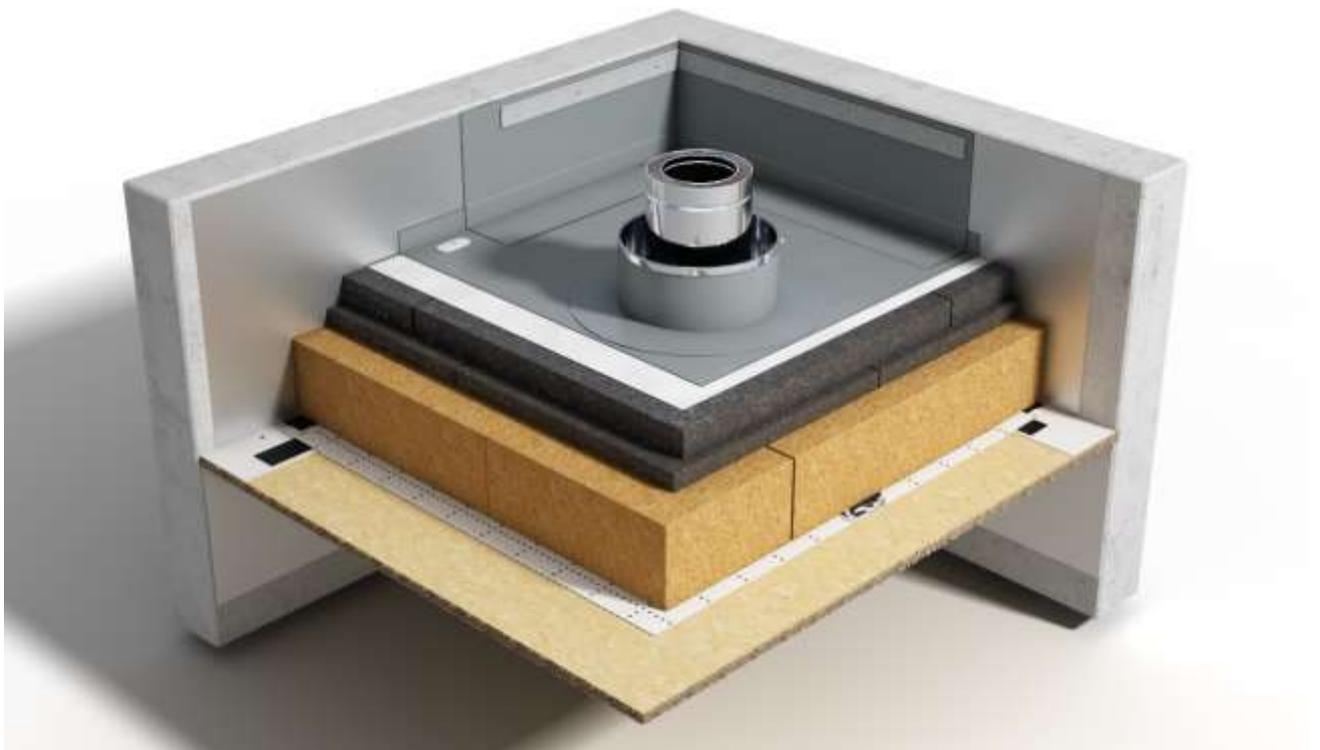
**Figure 35 : Pose et fixation de l'étanchéité en plan courant avec le relevé d'étanchéité le long du solin.**
