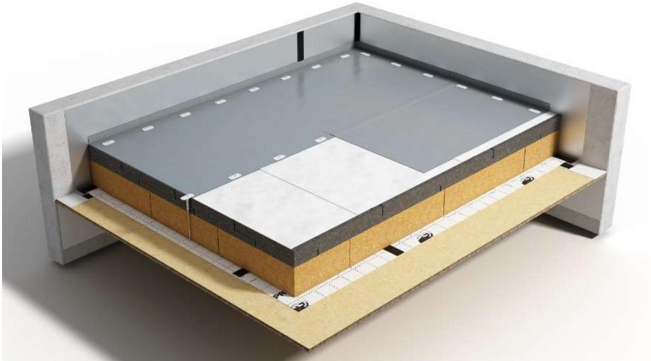
**Figure 8 : Pose de la membrane d'étanchéité FLAGON SR ou FLAGON SR/FR M2, fixation mécanique de la membrane par fixations à rupture de pont thermique et soudure des lés.**
