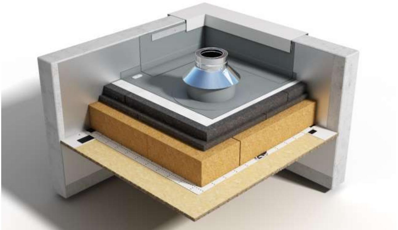
**Figure 36 : Pose de la collerette de protection en tête de relevé autour du conduit.**
