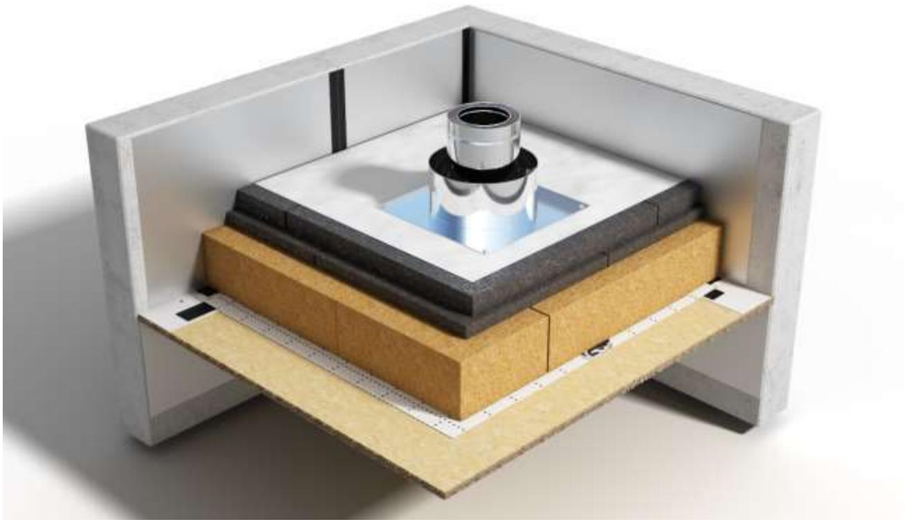
**Figure 34 : Pose et fixation du solin de toiture.**
