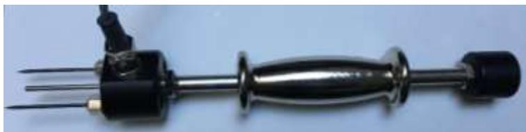
Figure 42 - Exemple d'humidimètre à pointe
