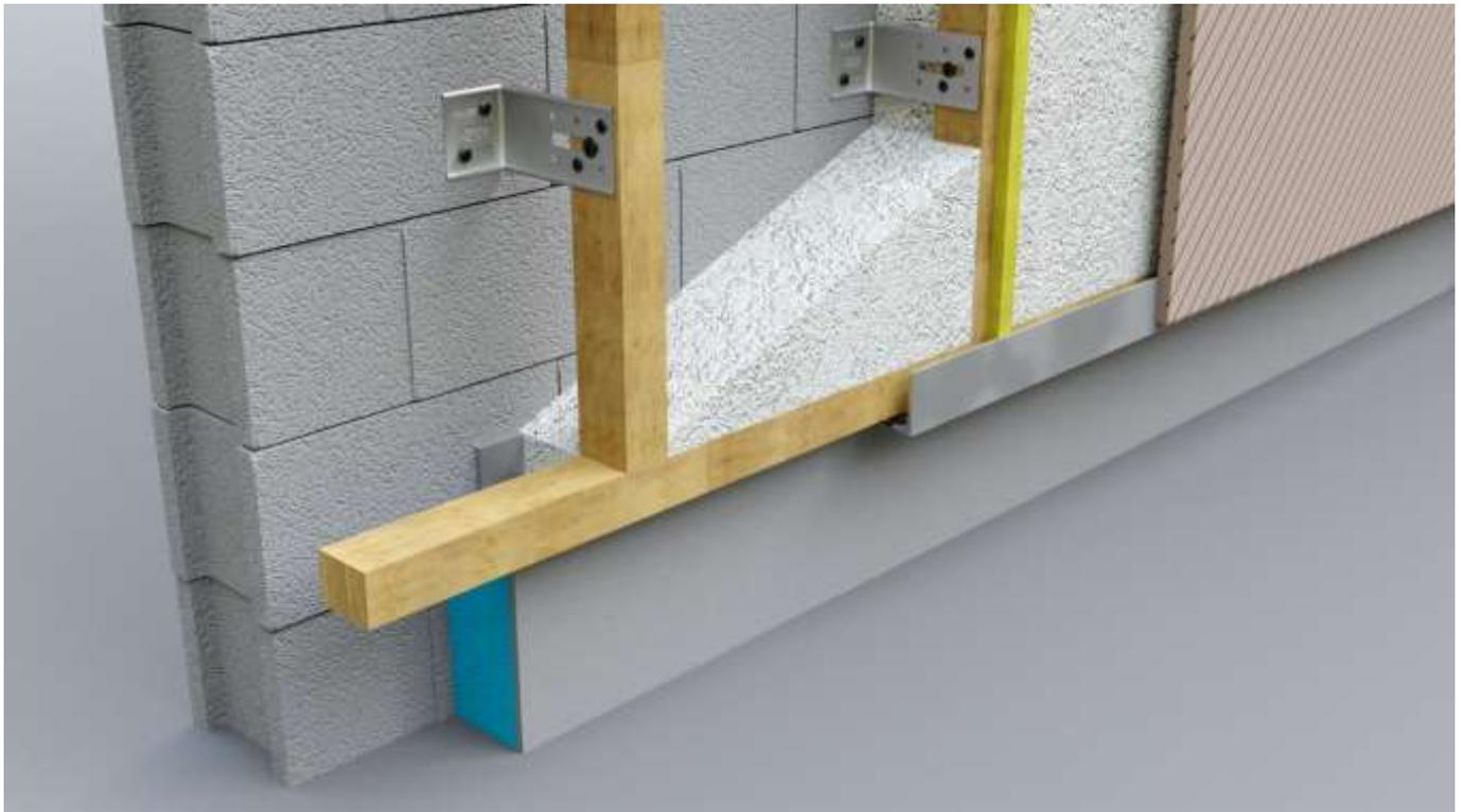
Figure 14 : détail pied de mur arrêt isolation extérieur / raccord continuité thermique garde au sol de 15 cm
