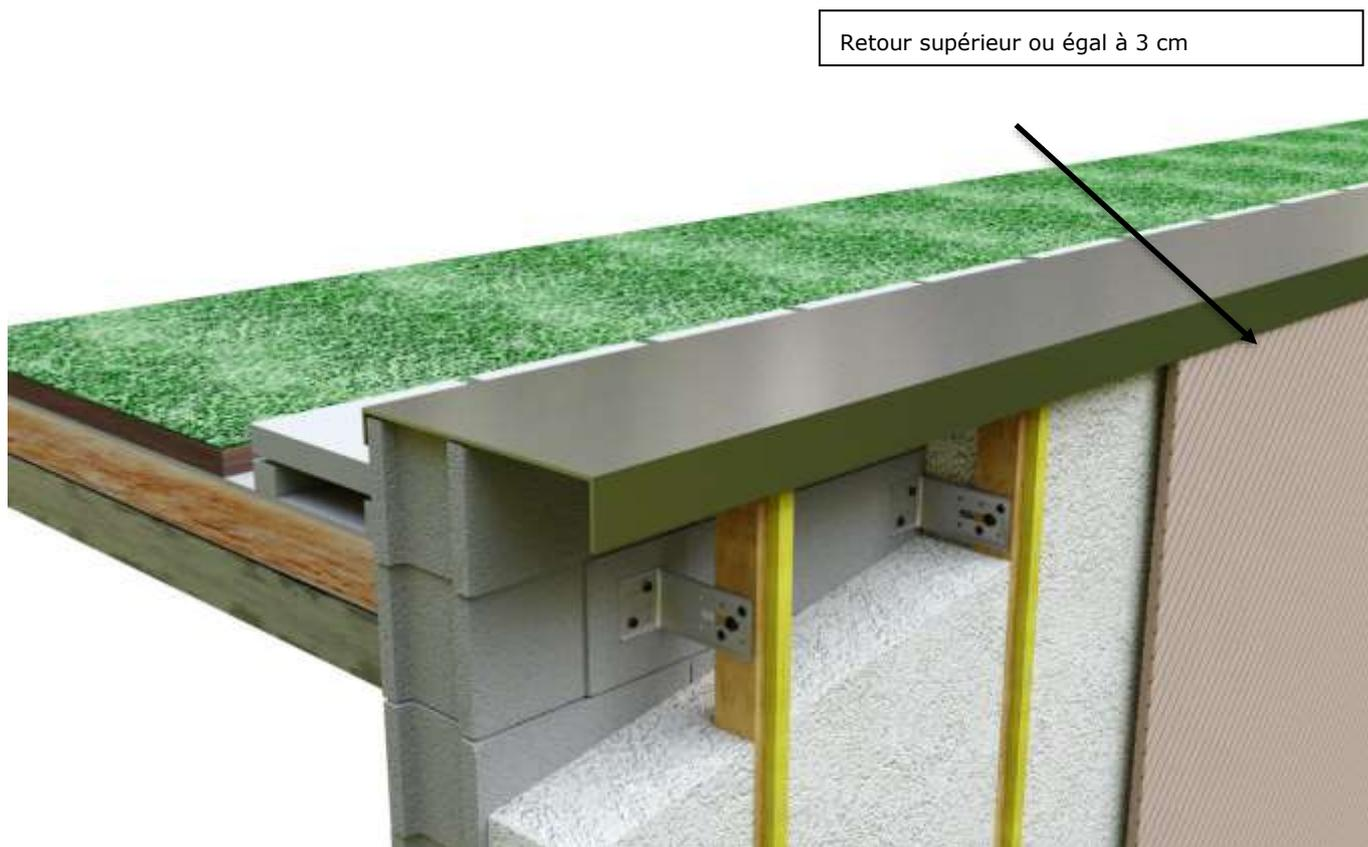
Figure 10 : détail raccord acrotère cas de la toiture terrasse le retour de la couverture recouvre le bardage sur plus de 3 cm
