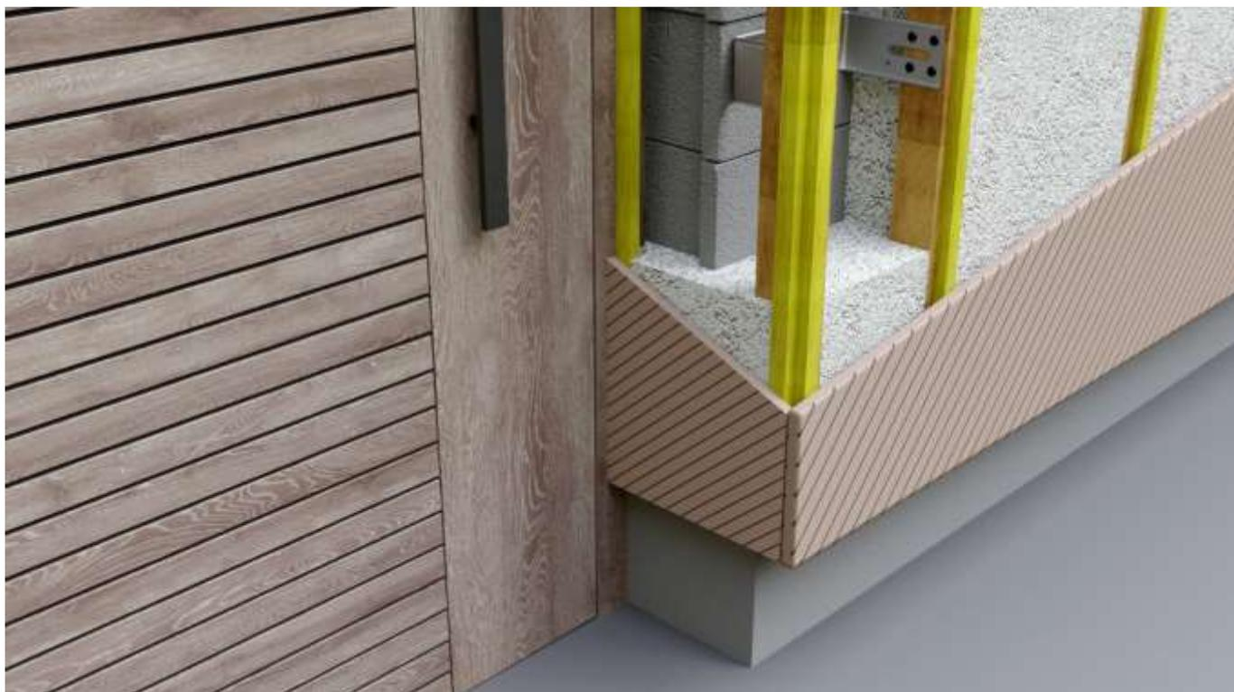
Figure 5 : détail raccord de l'isolant avec porte accès
