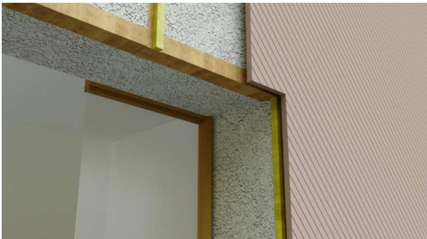
Figure 2 : détail retour isolant sur linteau et jambage fenêtre continuité thermique jusqu'au dormant de menuiserie
