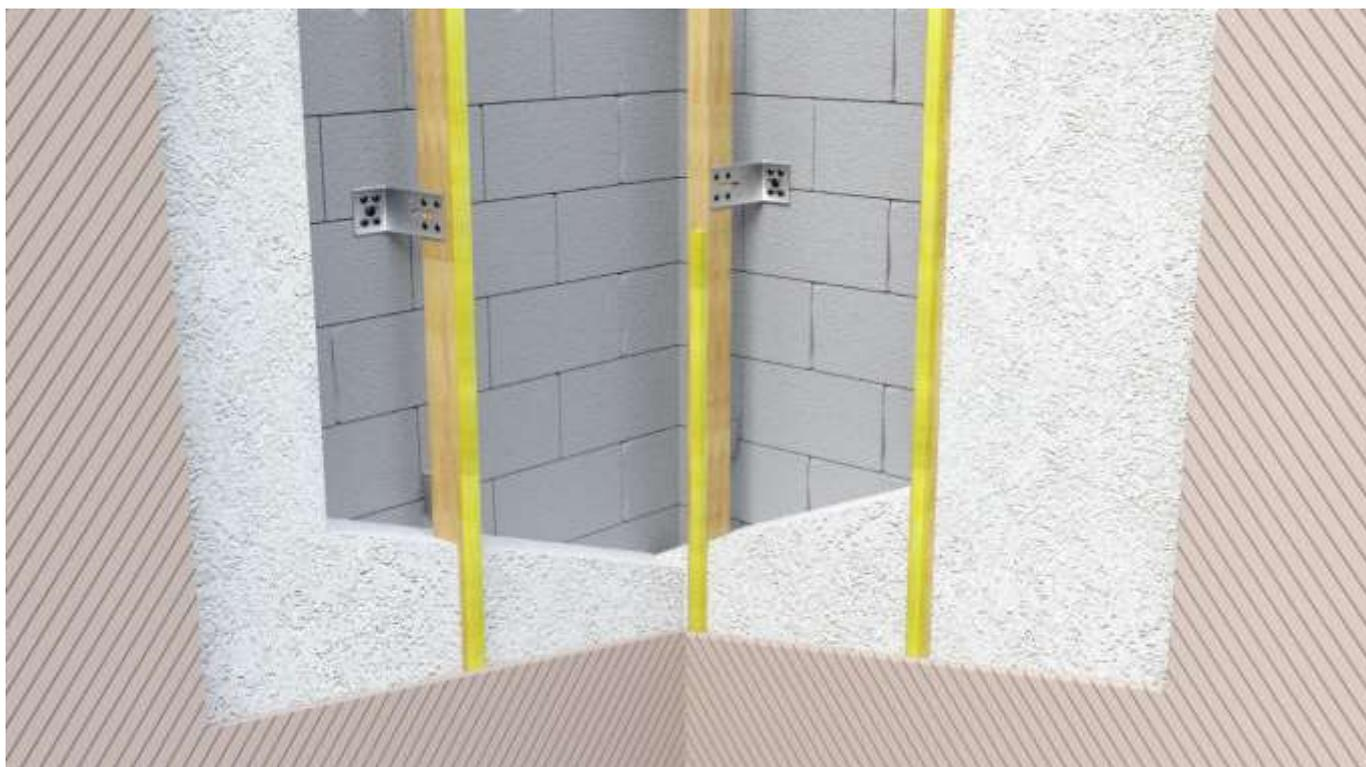
Figure 8 : détail continuité thermique angle rentrant paroi courante
