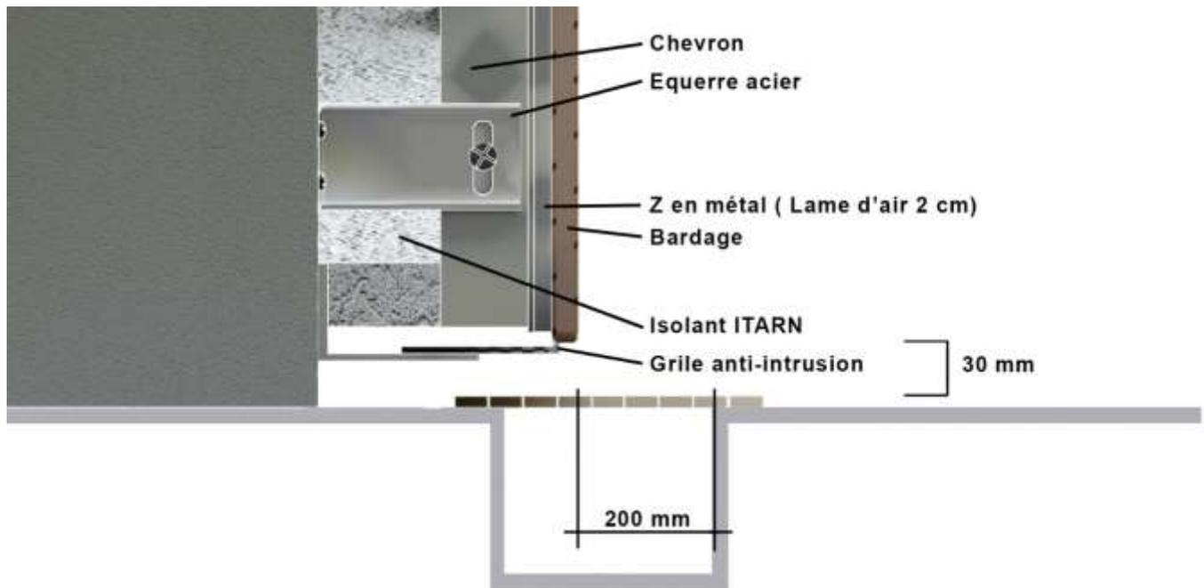
Figure 17 : exemple de traitement de départ du bardage paroi maçonnée
