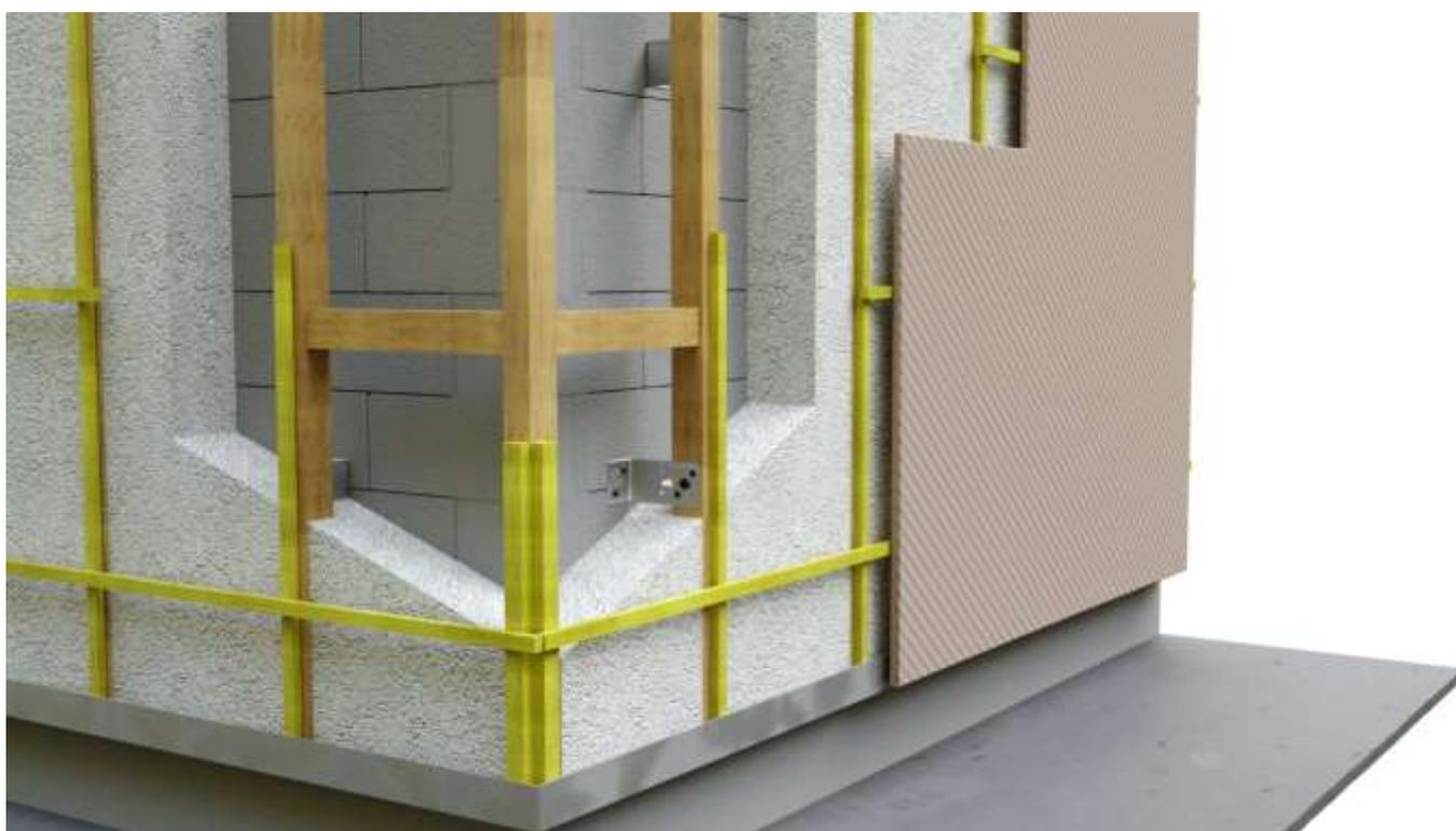
Figure 9 : détail continuité thermique angle sortant
