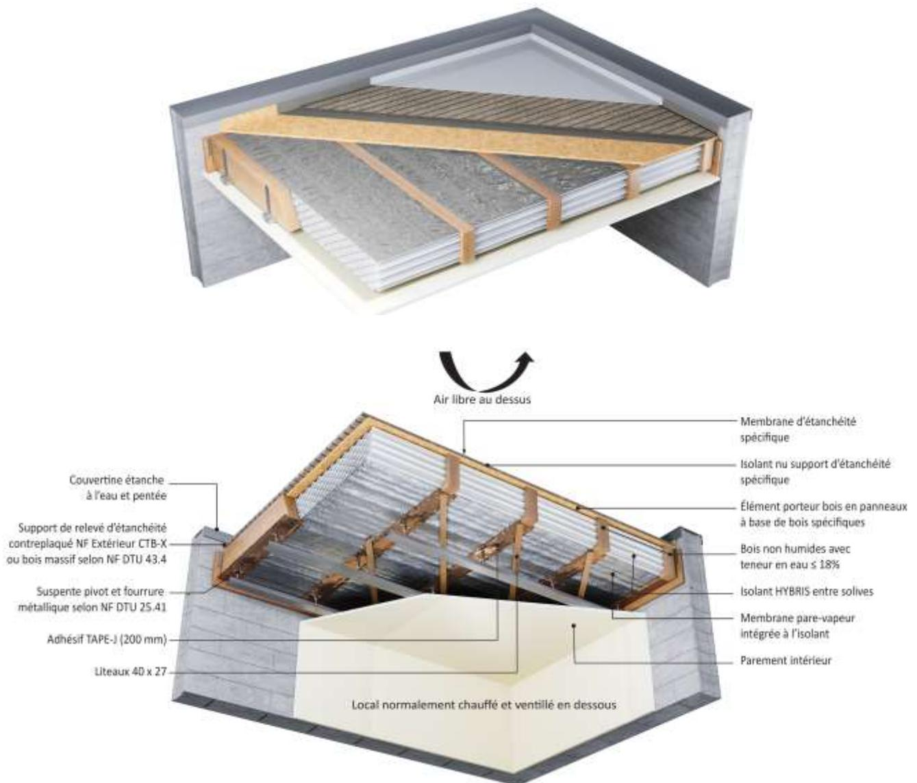
**Figure 1** - Vue d'ensemble du procédé « HYBRIS TOITURE PLATE BOIS »
