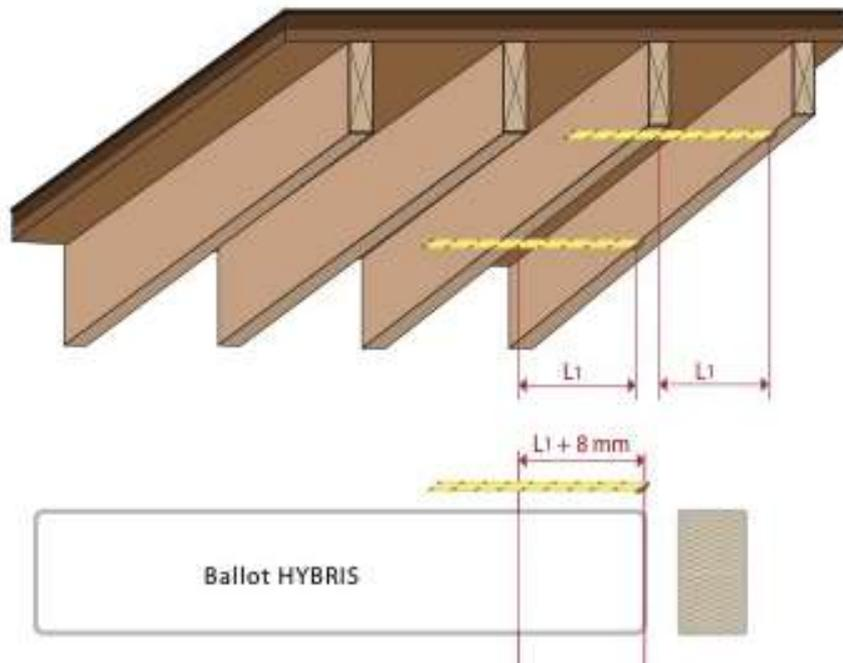
Figure 6 – Principe de surcote à la découpe des panneaux HYBRIS
