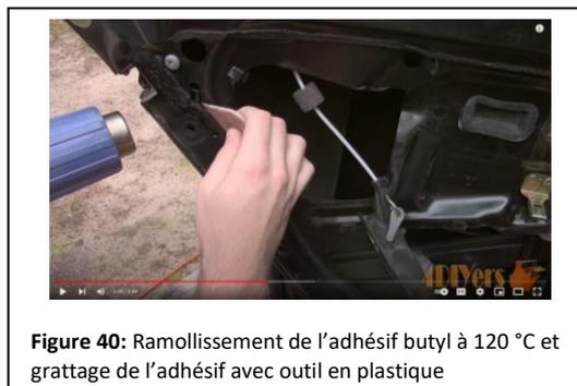
Figure 40: Ramollissement de l'adhésif butyl à 120 °C et grattage de l'adhésif avec outil en plastique
