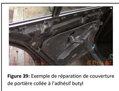
Figure 39: Exemple de réparation de couverture de portière collée à l'adhésif butyl
