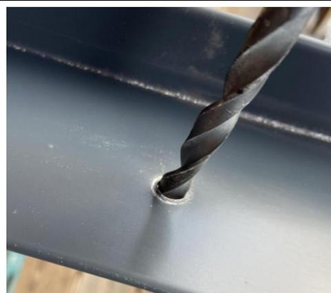
**Etape 2** : Finir le trou dans la tôle avec une mèche de 10 mm
