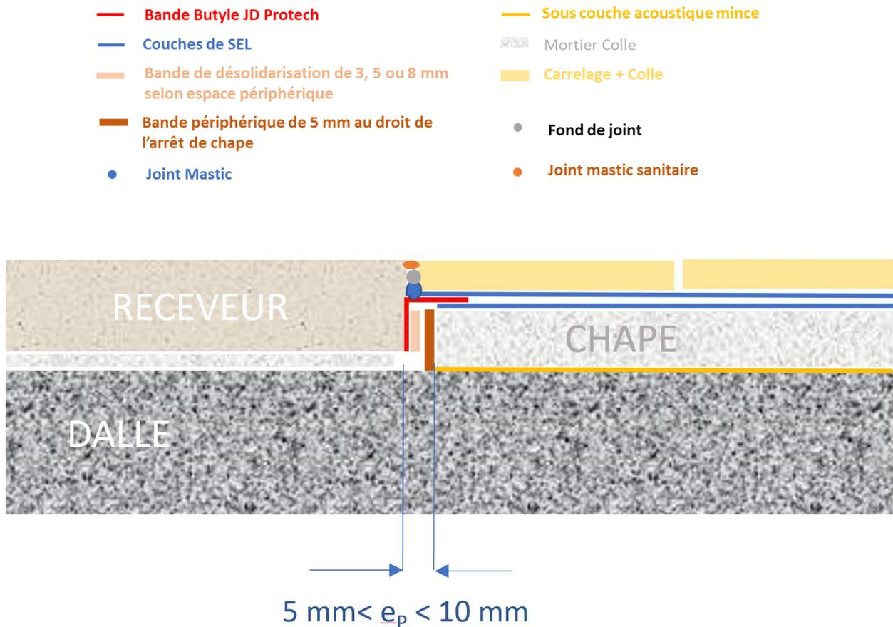
Figure 8 : Principe du raccord du procédé JD PROTECH avec la chape désolidarisée ou flottante
