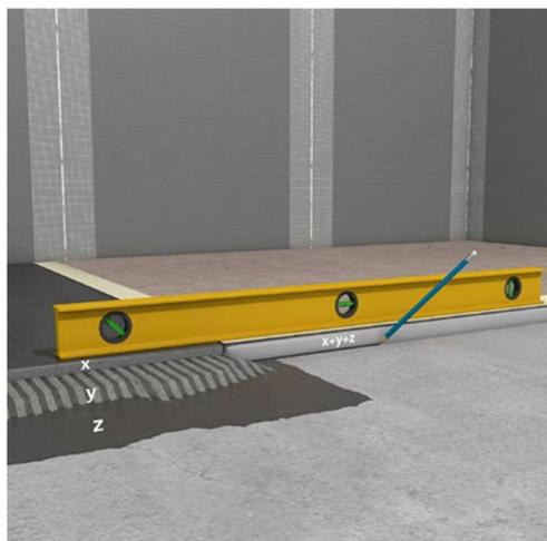
figure 1 : position de la ligne de débord du receveur avec la chape ou « ligne zéro ressaut ».
