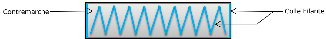
Figure 4 : Traitement des contremarches par collage
