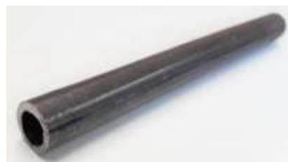
Photo 8 : Outil pour l'installation des attaches murales (chasse clou)
