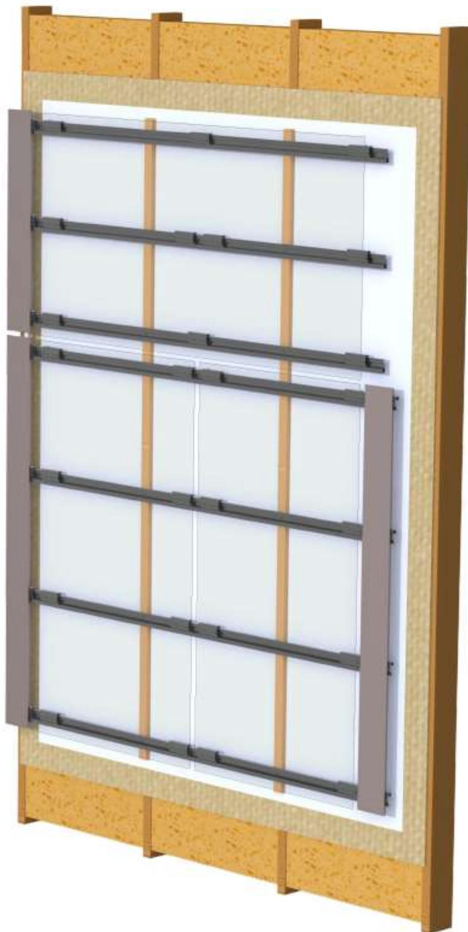
**Figure 25 – Raccordement lisses horizontales PRO-3456 sur COB**
