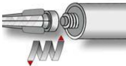
Fixer l'embout mélangeur fourni avec la cartouche et installer la cartouche dans le pistolet approprié. Pour chaque interruption de travail supérieure au temps de gel recommandé, une nouvelle buse doit être utilisée.
