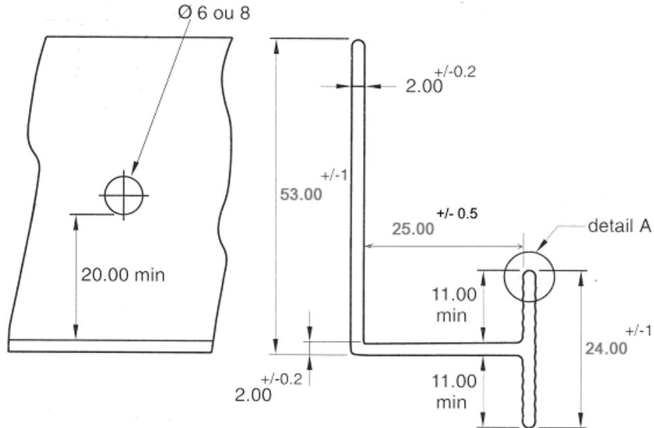
**Profils de fixation horizontaux et verticaux**
