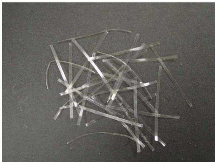
Photo 1 : fibre STRUX vierge, avant introduction dans béton
