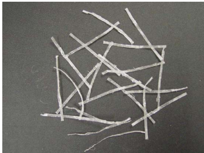
Photo 4 : fibre STRUX extraite d'un béton âgé de 3 ans, et lavée
