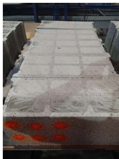
Aspect mousse après rectification : pas de manque ni de trous beau rendu
