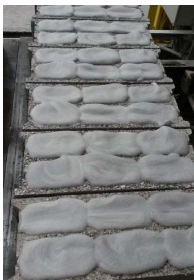
Pas d'affaissement, ni de décohésion, ni de fissures de la mousse. Elle a durci sans retrait ni gonflement.
